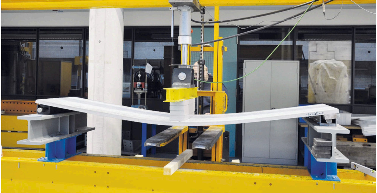
Abb. 3.8.13: Lastabhängiges Verformungsverhalten einer dünnen Platte aus Ultrahochleistungsfaserbeton (siehe Ultrahochleistungs-Faserbeton).
