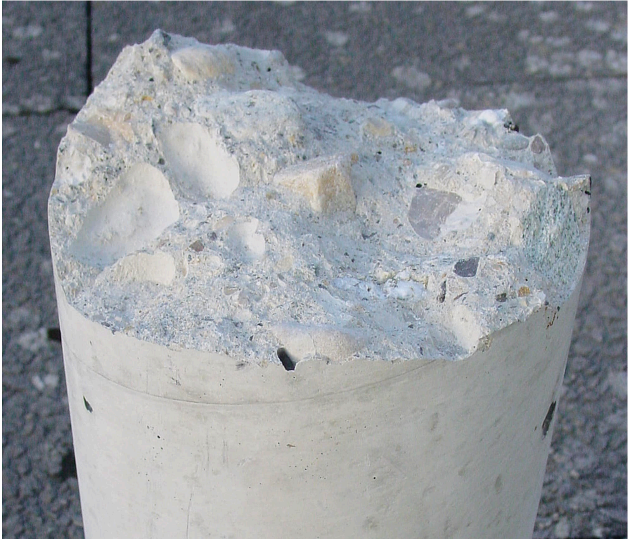
Abb. 3.8.7: Bruchbild nach direkter Zugbelastung eines Prüfkörpers. Versagen in der Verbundzone.
