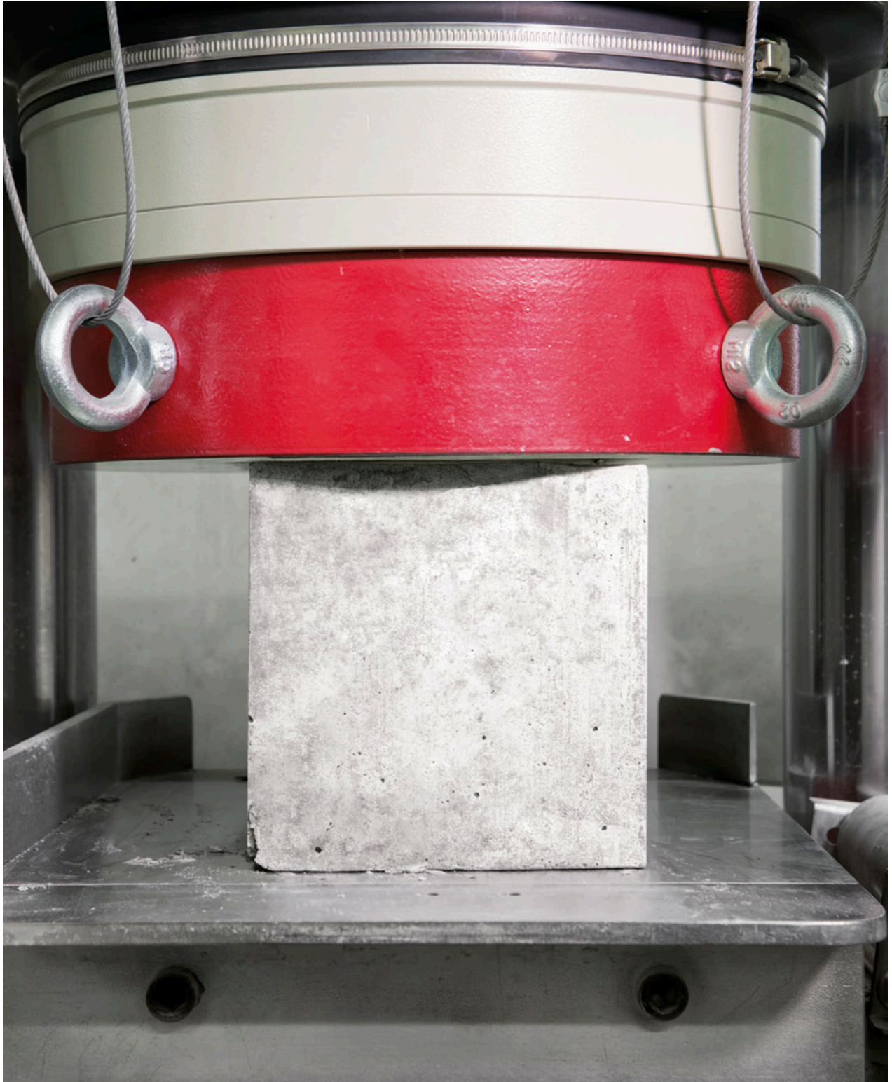
Abb. 3.8.1: Prüfung der Druckfestigkeit am Würfel.
