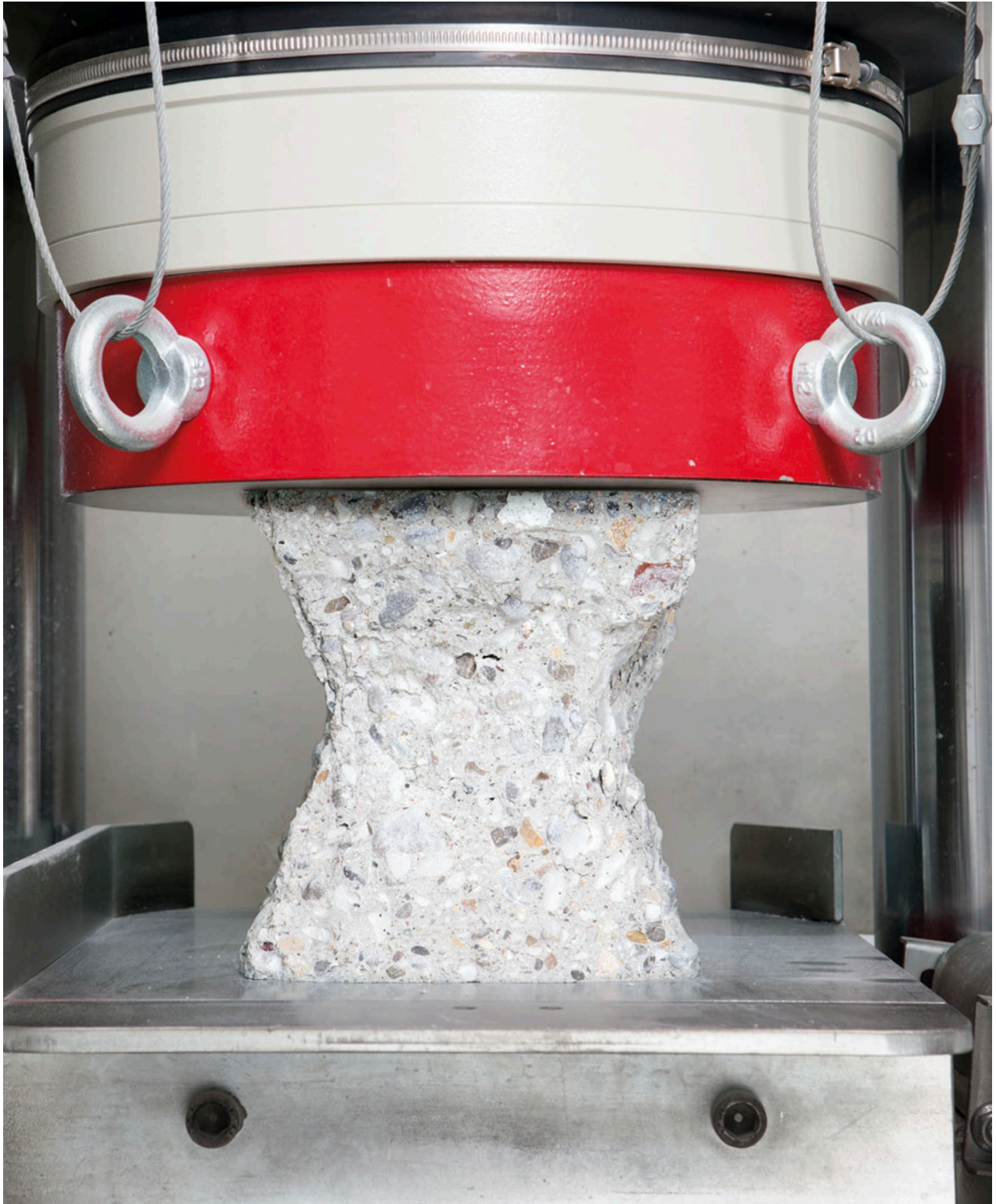
Abb. 3.8.2: Bruchbild eines Würfels.
